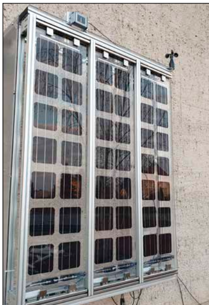
Bild 3: Der Demonstrator des PI-Berlin – noch ohne Grünfassade, aber oben mit Solar- und Windmessern.
