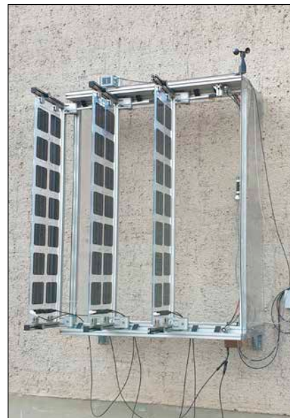
Bild 4: PI-Berlin: Die einzelnen bifazialen Module können dem Sonnenstand einachsigt nachgeführt werden.
