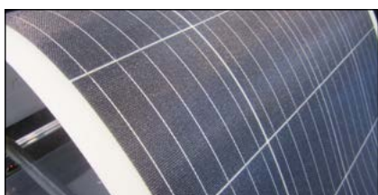
Bild 6: Detailaufnahme der flexiblen, gebogenen Solarzelle
