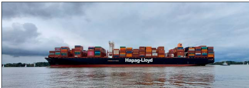
Bild 2: Die 400 m lange und 58,6 m breite Al Nefud mit ihren 18.800 TEU zeigt deutlich die Trennung zwischen Brücke vorn, und der Maschinenanlage (oranjer Schornstein) hinten.
