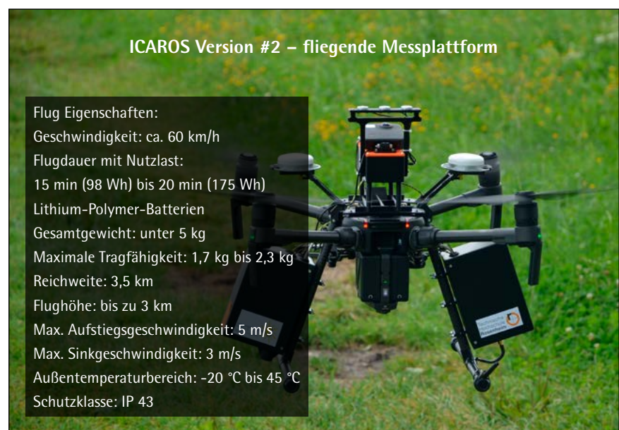
Bild 1: Das Bild zeigt den verwendeten Quadrocopter (DJI Matrice 210 RTK) mit einem Gesamtgewicht unter 5 kg und einer maximalen Traglast von 2,3 kg. Schön zu sehen sind der Top-Case als Sensorplattform – auch für weitere, neue Sensoren und die beiden Side-Cases oder Pollensäcke mit der Mess- und Kommunikationstechnik.
