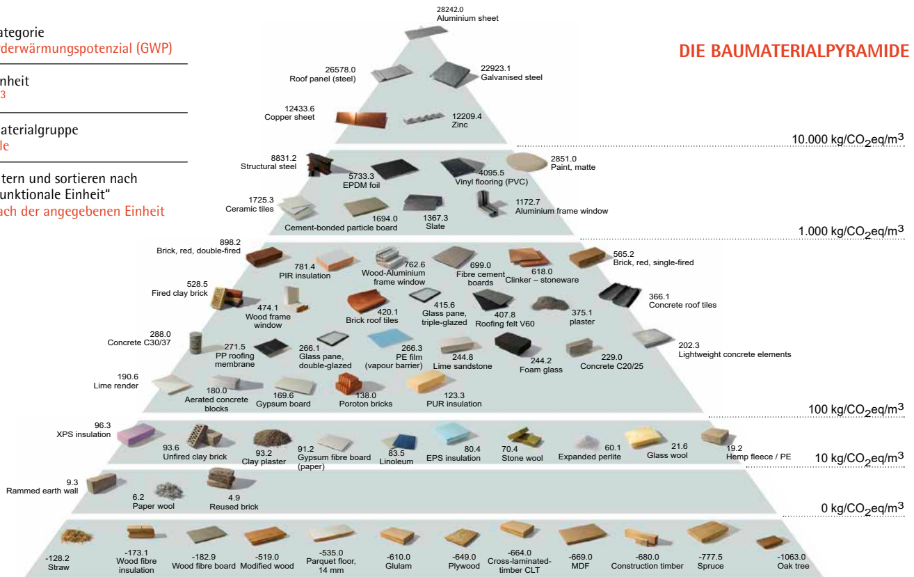
Bild 2: Basierend auf der grafischen Sprache der Lebensmittelpyramide hat das Zentrum für industrialisierte Architektur (CINARK) an der königlichen dänischen Akademie eine interaktive digitale Version der Baumaterialpyramide entwickelt [Quelle: https://materialepyramiden.dk ]
