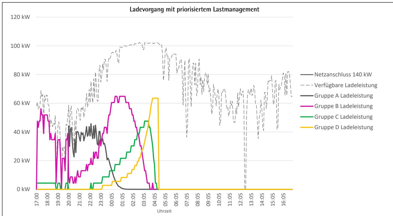
Bild 3: Ladevorgang für die Fahrzeuggruppen A bis D
