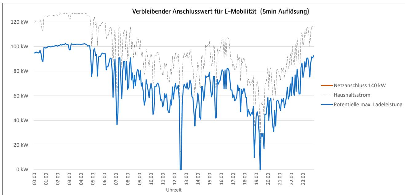
**Bild 2: Maximal verfügbare Ladeleistung mit 25 kW Puffer bis zum Netzanschluss 140 kW**
