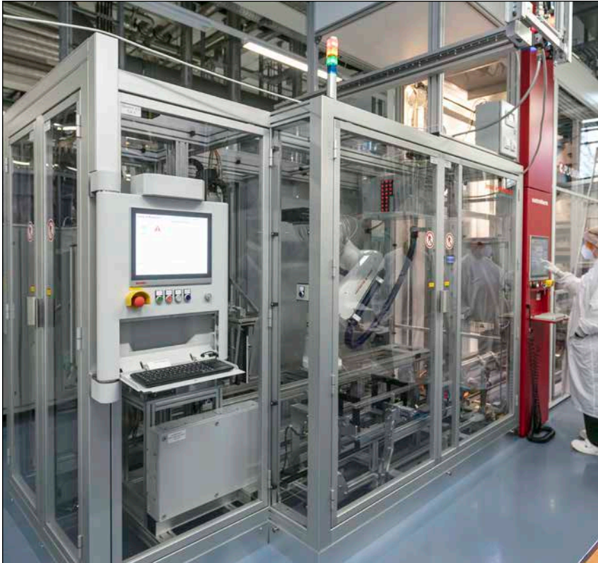
Bild 1: Hochdurchsatz-Plasmabeschichtungsanlage im ISFH SolarTec-Technikum im Bereich der Optimierung für Solarzellenfertigung.
