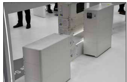
Bild 2: Modulare Heimspeicher in verschiedenen Größen
