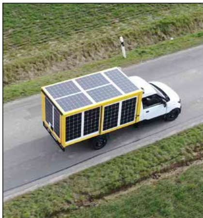
Bild 2: Lieferfahrzeug mit integrierter Solarmodulen. Die Module erweitern die Reichweite des Fahrzeuges.
