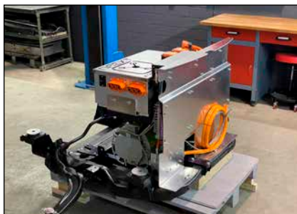
Bild 2: Ein komplettes E-Antriebsmodul für einen VW T5/T6
