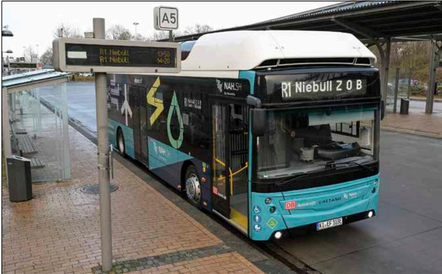
Bild 1: Alltag am ZOB von Niebüll: Der mit Wasserstoff betankte Bus ist startklar
