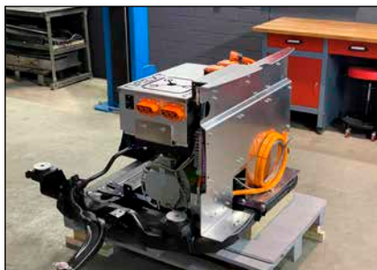
Bild 2: Ein komplettes E-Antriebsmodul für einen VW T5/T6
