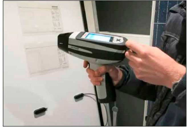
Bild 6: Untersuchung der Rückseitenfolien von Solarmodulen mit mobilen Geräten zur FTIR (Fourier Transform Infrared Spectroscopy)
