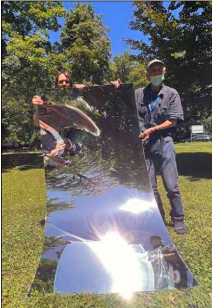
Bild 1: Ulrich Kaiser präsentiert einen Acrylglas-Spiegel, wie er auch bei der SunMachine verwendet werden soll
