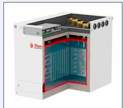
Bild 2: Das Phasenwechselmaterial kann rund dreimal mehr Energie als Wasser mit gleichem Volumen speichern. Jede Einheit verfügt über zwei Wärmetauscher. Einer davon erlaubt auch die Ladung durch Solarthermie oder andere Wärmequellen, die Kapazität für die Entladung bleibt dabei voll erhalten.
