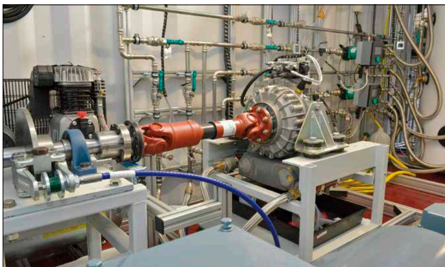
Bild 3: Thermodynamischer Retarder, der aus mechanischer Drehung Wärme generiert.
