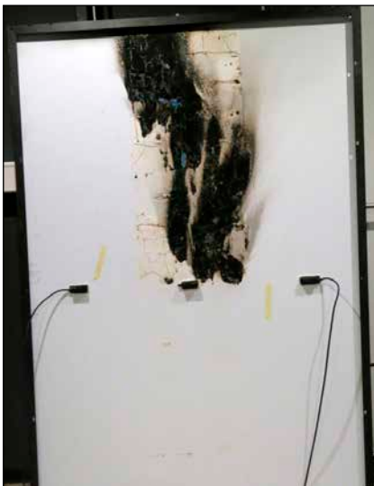
Bild 4: Solarmodul mit einer offenen Bypassdiodenstrecke am mittleren Substring.
