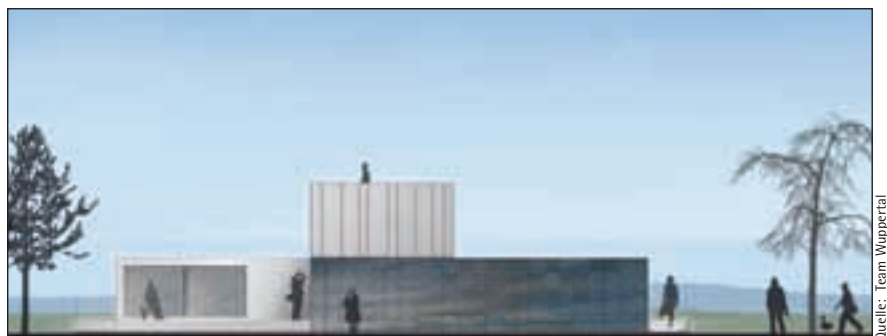
Bild 7: Solarwand mit verschiedenfarbigen Solarzellen für eine individuelle Fassadengestaltung
