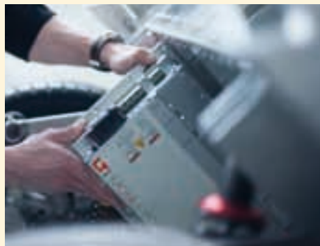
Bild 2: In der zentralen Leistungselektronik eines Elektroautos laufen alle Energieflüsse zusammen. Dies ist der perfekte Ort, um den mobilen Fahrstromzähler zu integrieren.
