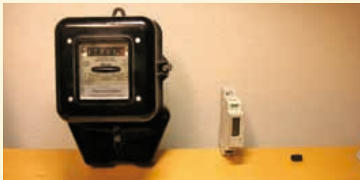
Bild 1: Die alten mechanischen Zähler sind Bauart bedingt sehr groß. Moderne Hutschienenzähler zeigen, dass man die notwendige Technik auch deutlich kompakter und unempfindlicher machen kann. Ein Strommesschip ist nicht viel größer als der „schwarze Klecks“ rechts.
