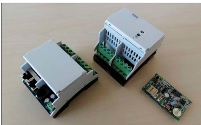
Bild 2: Der aus dem Babelbee-Projekt heraus entstandene Stromnetzanalyse-Computer mit Embedded-Linux kann die Netzfrequenz (und 100 weitere Netzkennzahlen) mit hoher Auflösung erfassen und diese Messwerte dokumentieren.
