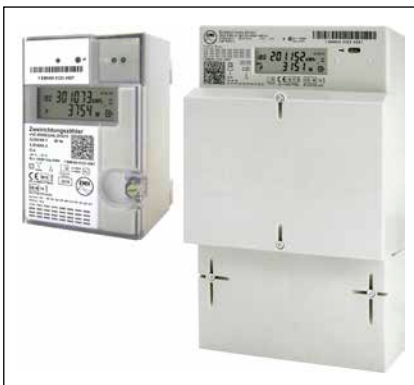
Bild 2: Intelligente Basiszähler „iZ“ in BKE-Bauform (links) sind von heute üblichen „eHZ“ nach EDL21-Standard äußerlich kaum zu unterscheiden, unterstützen aber die Kryptografie des Messsystems 2020. Größere Basiszähler (rechts) verfügen über eine Klappe, hinter der sich ein Smart-Meter-Gateway installieren lässt, das mehrere iZ zu einem intelligenten Messsystem „iMSys“ aufrüsten kann.
