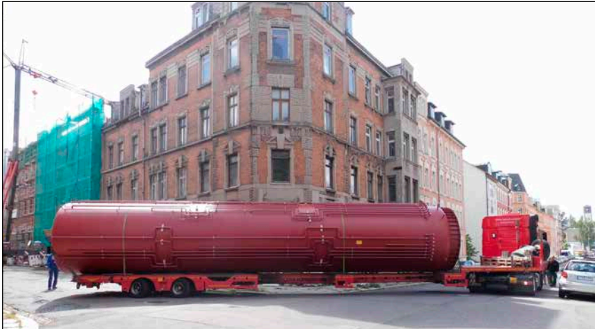
Bild 1: Altbausolarisierung: Statt graue Energie aufzuwenden, Sonnenenergie einlagern. Speicheranlieferung eines knapp 100 m 3 großen Solartanks
