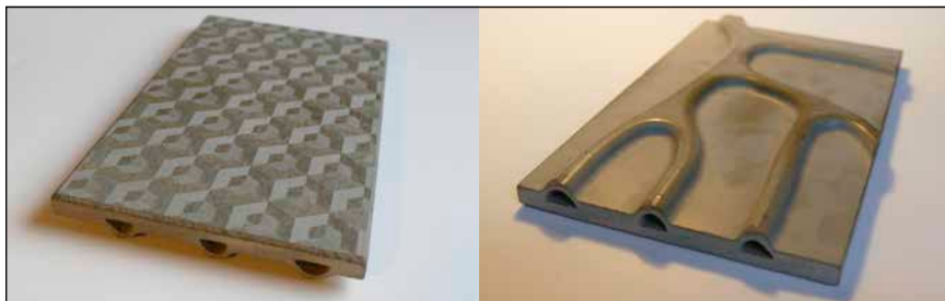
Bild 3: Mikro-Oberflächenstrukturierung (links) und FracTherm®-Struktur (rechts) als Gestaltungselement.
