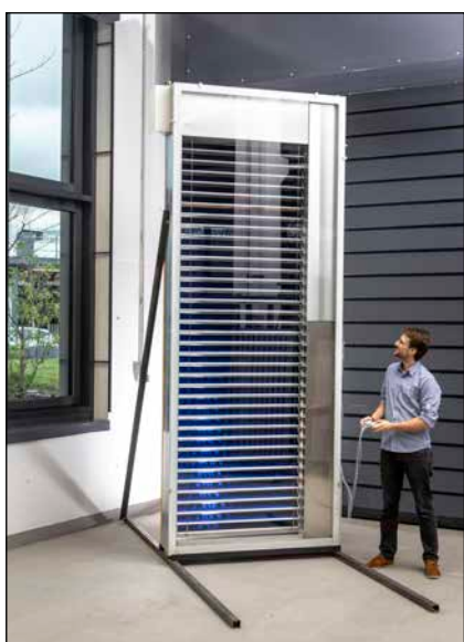
Bild 4: Die Solarthermische Jalousie, integriert in ein Doppelfassadenelement
