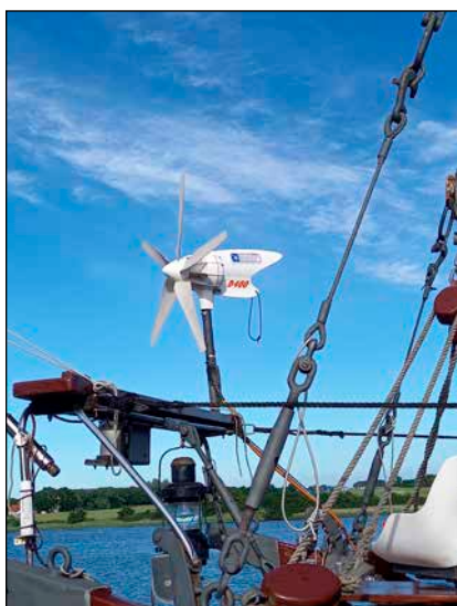
Bild 2: Sinnvoll: Microwindkraft zur Stromversorgung eines Segelboots
